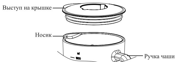
2. Вставьте колпачок в направляющие крышки и поверните колпачок по часовой стрелке.
