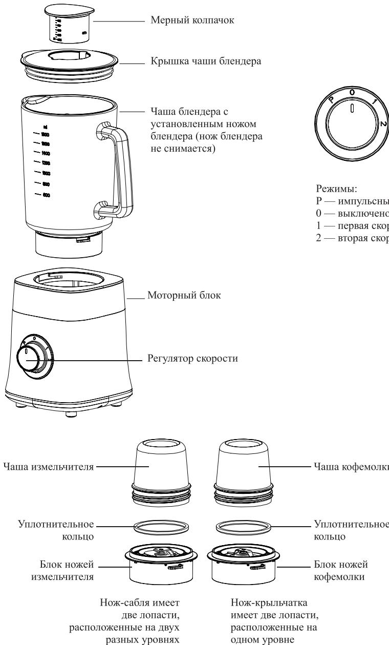
**Регулятор скорости** позволяет включить и выключить мотор блендера, включить импульсный режим или выбрать подходящую скорость работы.
